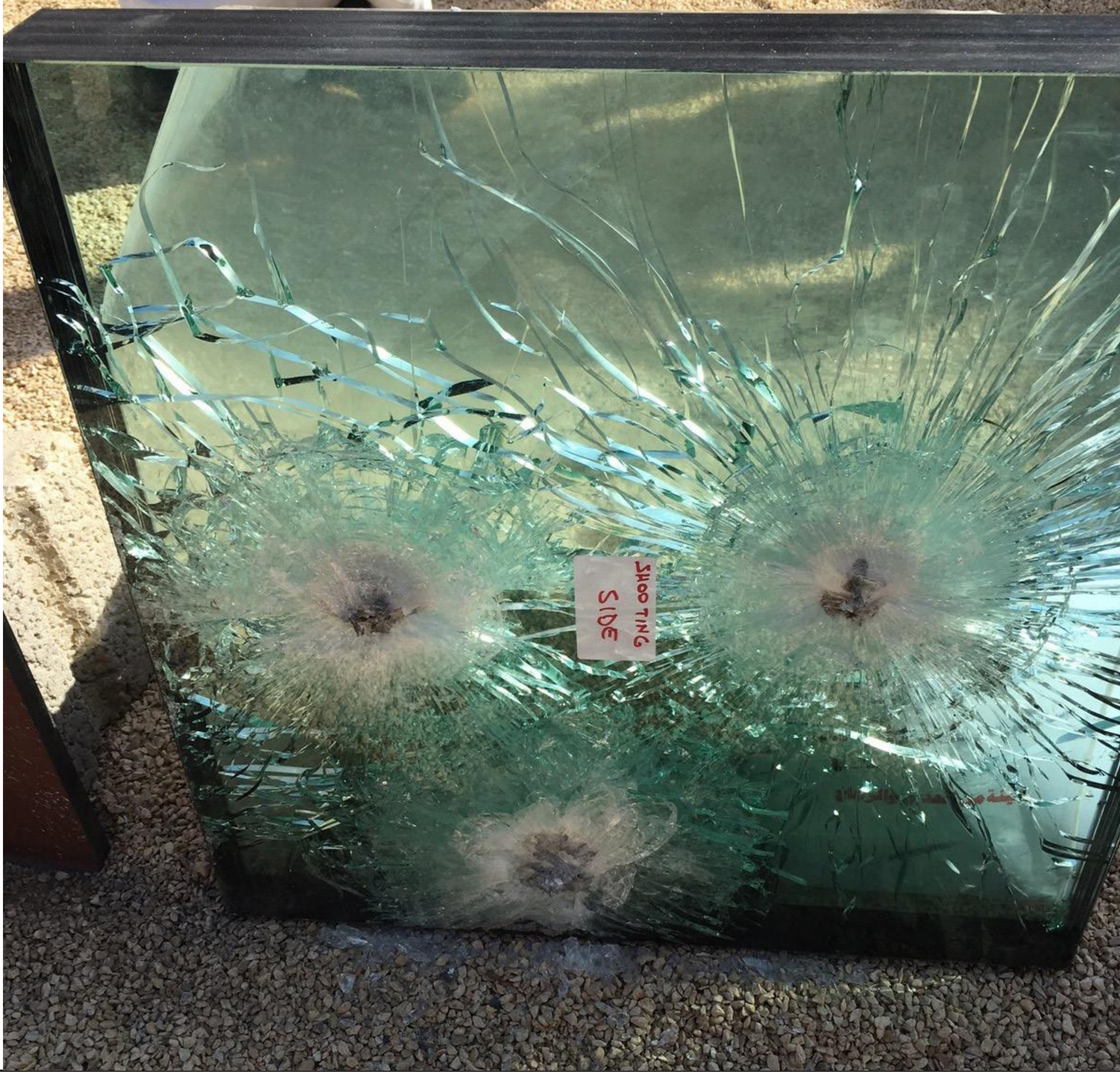
Test de balle réel pour le verre de classe de protection B7
